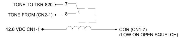
RADIO SHACK 12 VDC - SPST REED RELAY OR EQUIVALENT
